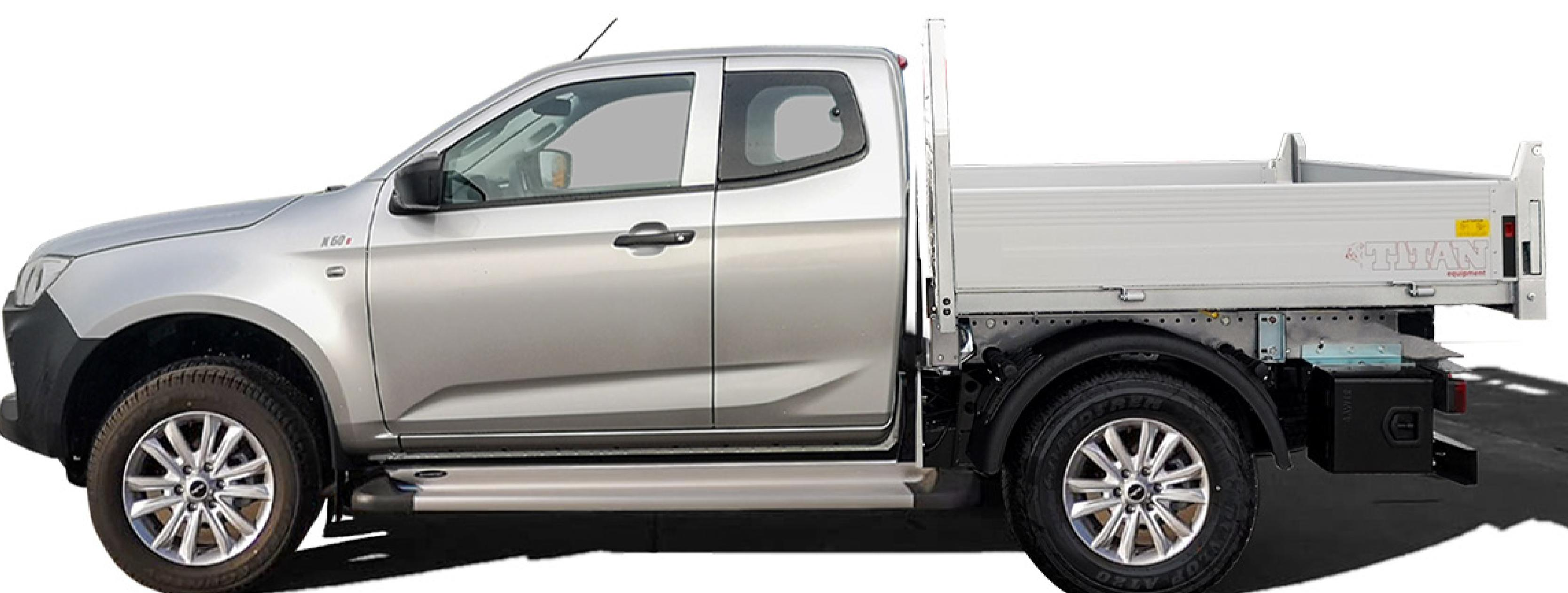
Ladebodenaufbau aus 4 mm starkem Einzel Blech Aluminium
